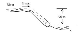
$$e_{\rm mech} = pe + ke = gh + \frac{V^2}{2} = \left( (9.81 \,\mathrm{m/s^2})(90 \,\mathrm{m}) + \frac{(3 \,\mathrm{m/s})^2}{2} \right) \left( \frac{1 \,\mathrm{kJ/kg}}{1000 \,\mathrm{m^2/s^2}} \right) = 0.887 \,\mathrm{kJ/kg}$$
